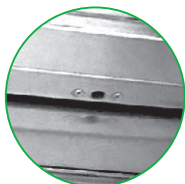
縦方向に設置された 補助光電センサー
