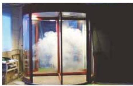
2010年 自動回転ドア換気量測定本実験
